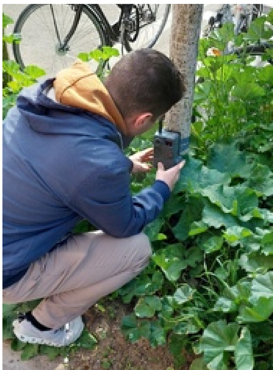
Abb. 16: Die Fotofalle lässt sich mit Hilfe eines Spanngurts an einem Baum oder Pfahl befestigen (© Julia Maurer / wildenachbarn.ch und Sandra Gloor / stadtwildtiere.ch).
