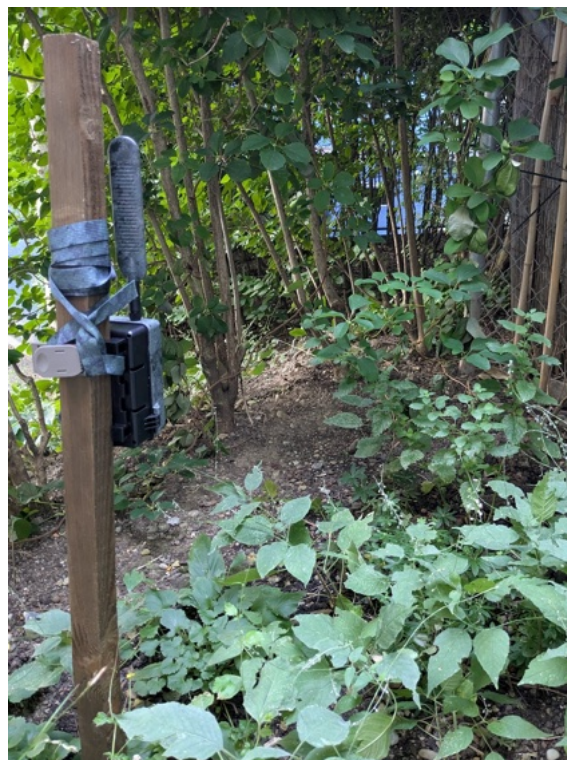
Abb. 16: Die Fotofalle lässt sich mit Hilfe eines Spanngurts an einem Baum oder Pfahl befestigen (© Julia Maurer / wildenachbarn.ch und Sandra Gloor / stadtwildtiere.ch).
